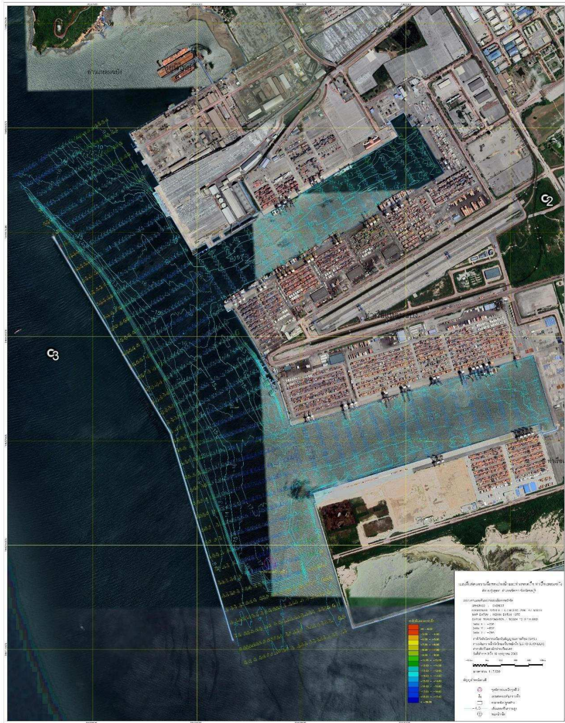
รูปที่ 12 การสร้างเลขระดับน้ำและเส้นชั้นความสูงจากโปรแกรมสำรวจ
